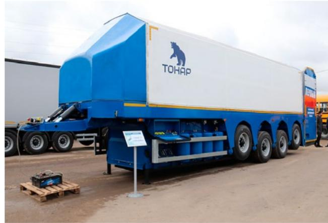
маневренность обеспечивают две подъемные (1-я – принудительное управление из кабины тягача и 2-я – автоматическая) и две поворотные (1-я и 4-я) оси, которые при этом еще и позволяют сокращать затраты на топливо и резину.
