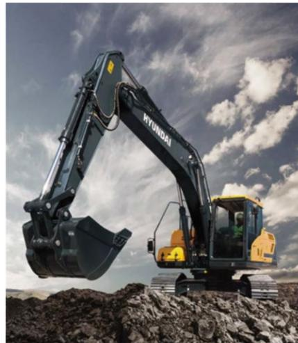
Полностью переработанная система управления позволяет с легкостью управлять этой машиной. На движения джойстиков экскаватор реагирует легко, плавно и точно, нет излишней резкости, как и избыточной чувствительности. Функции между джойстиками распределены по стандартной схеме: левый – рукоять и поворот платформы, правый – стрела и ковш, что является по сути стандартным для всех гусеничных экскаваторов.
