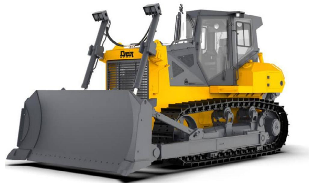
защищенность ходовой части бульдозера. Впервые такие гусеницы стали использовать на машинах Caterpillar: инженеры бренда сместили бортовой редуктор вверх и вперед, расположили выше приводную «звездочку». А в 1996 году компания Case представила трактор QUADTRAC с треугольными гусеницами.
