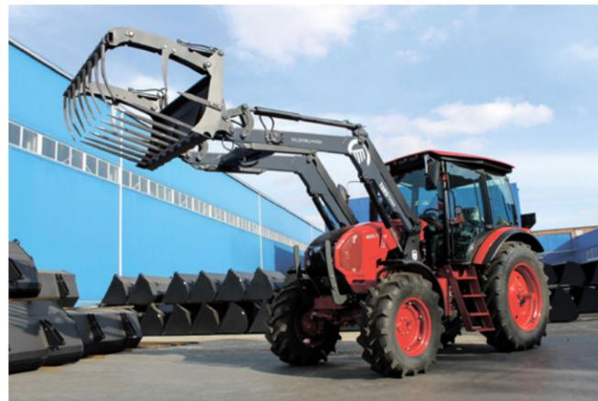
Теперь TURS-1500M агрегируется на модели МТЗ 1222.3 и 1523.3 (исполнение с пластиковым топливным баком).
