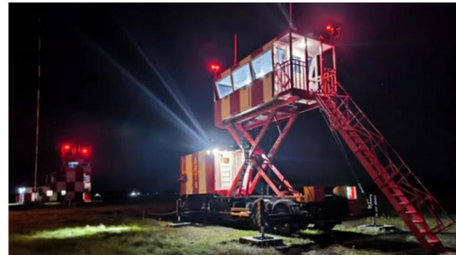
Компания «Политранс» (входит в Ассоциацию «Росспецмаш») разработала специальное шасси для установки мобильного стартового диспетчерского пункта.
